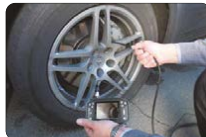
Esempio: Controllo delle pastiglie dei freni
